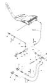
ETB-013090, гидравл.управление одинарных заслонок со стопорным устройством
